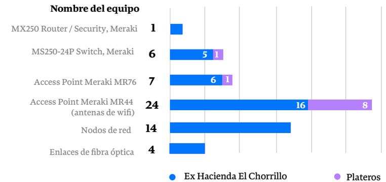
Para el esquema de seguridad de la red FAD Taxco, se optó por implementar la plataforma de tecnología *Cisco-Meraki*, que proporciona escalabilidad, fiabilidad y una gestión centralizada de la red desde la nube. Esta elección garantizó una infraestructura de seguridad robusta y una mayor capacidad para administrar usuarios, aplicaciones y dispositivos a través de políticas de red. Además, permitió un monitoreo y análisis continuo, así como la generación de informes.
