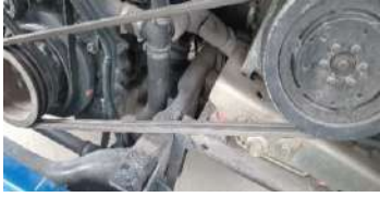
CAMBIO DE BANDAS DE SISTEMA DE AIRE ACONDICIONADO Y ALTERNADOR
